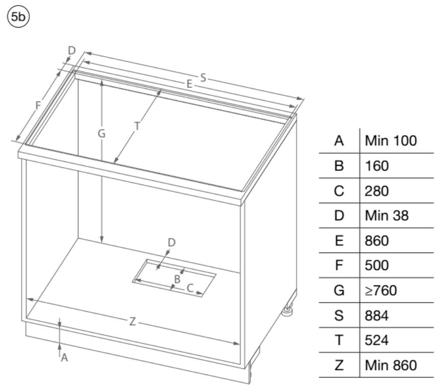
5a **Hauteur G $\geq$  760mm pose standard**
