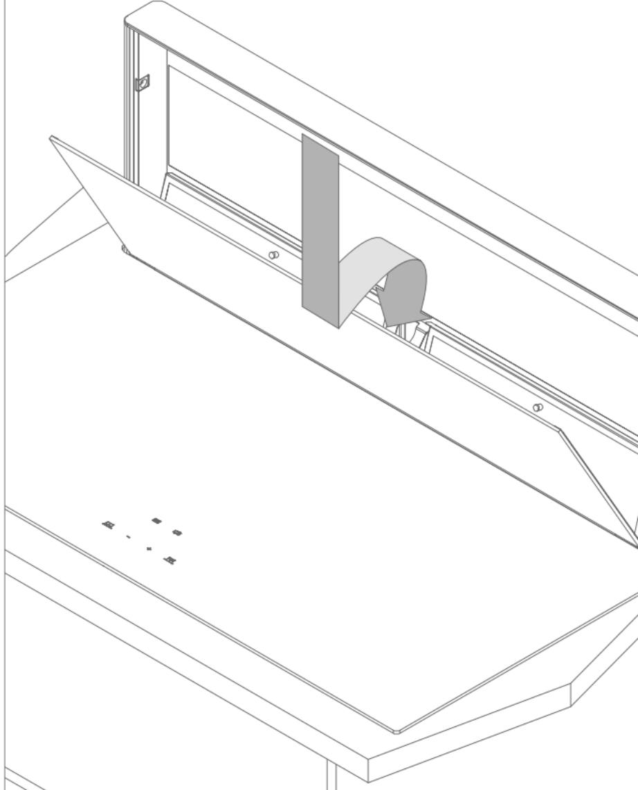
④2 Platzieren Sie die vordere Glasplatte (1821126) auf dem Lüftungsschirm des Dunstabzugs.
