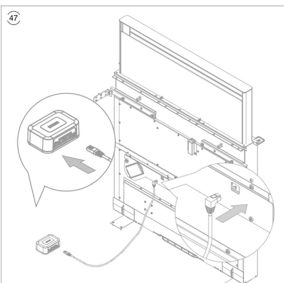
**(46) OPTIONAL: Installation eines I/O-Schalter-Moduls (Fensterkontakt) (990036).**
