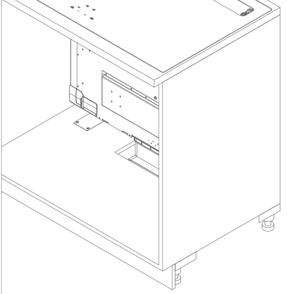
(25) Stellen Sie sicher, dass die Kante des Ausschnitts im Induktionskochfeldglas mit den Seitenprofilen des Lüftungsschirms ausgerichtet ist.
