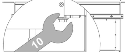
28 29 Réglez, si nécessaire, la hauteur de la tour en fonction du bord supérieur de la plaque de cuisson.
