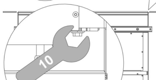
28 29 Regel indien nodig de hoogte van het glas van de toren bij ten opzichte van het glas van de kookplaat.
