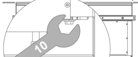
28 29 Passen Sie bei Bedarf die Höhe des Lüftungsschirms in Bezug auf die Oberseite des Kochfelds an.
