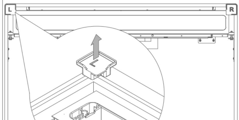
(21) Ajustez si nécessaire la position au moyen des vis (le boulon et le contre-ecrou 906136 + 906173) de réglage.
